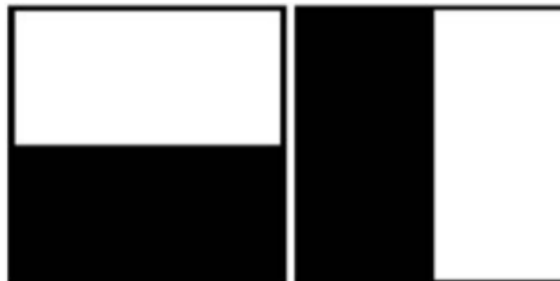
13 pav. Haar bangų tipai naudojami SURF požymių išskyrimo metode (Bay, H.; Ess, A.; Tuytelaars, T. and Gool, L. V., 2008)
